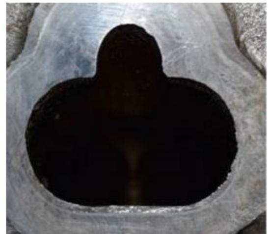
L'ajustement du conduit de culasse côté admission est interdit. Toute trace de limage, meulage, microbillage... est prohibée. Le conduit du collecteur d'admission peut être ajusté ainsi que le joint. De la matière peut être enlevée, il est interdit de rapporter du métal. Les traces d'usinage correspondant à l'ajustement du collecteur d'admission à la culasse ne doivent pas dépasser 10mm de la face d'appui du joint.
