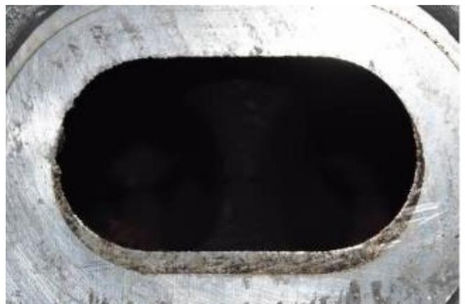
L'ajustement du conduit de culasse côté échappement est interdit. Toute trace de limage, meulage, microbillage... est prohibée. Le conduit du collecteur d'échappement peut être ajusté ainsi que le joint. De la matière peut être enlevée, il est interdit de rapporter du métal.
